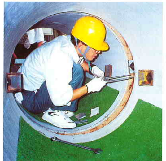
継手拔出長測定状況
