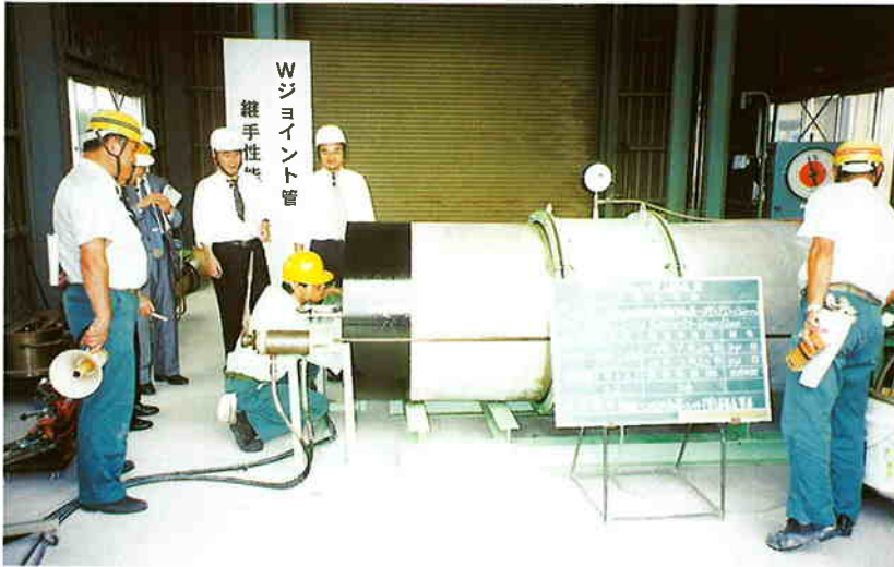
継手型式試験によりJ-2及びJ-2NはJSWAS A-2-1999に適合した推進管であることが確認されました。
