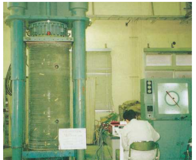
加圧時の管体部に生ずるひずみなどを調査し、所定の許容推進力を有していることが確認できました。
