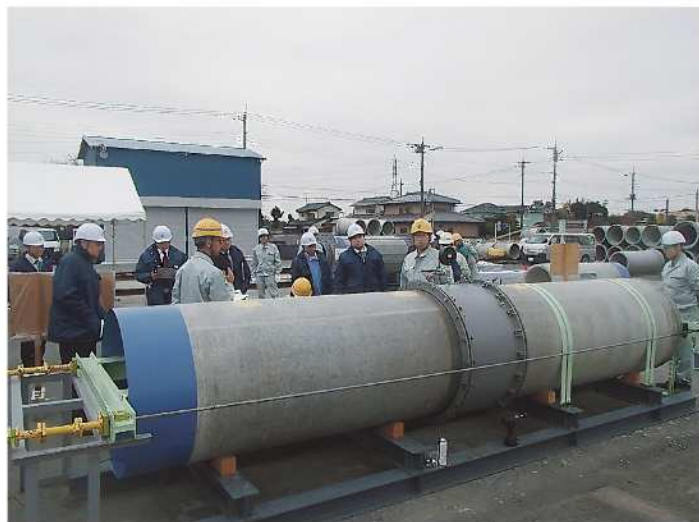
継手型式試験によりJ-2、J-2NおよびJ-2DはJSWAS A-2-2018に適合した推進管であることが確認されました。
